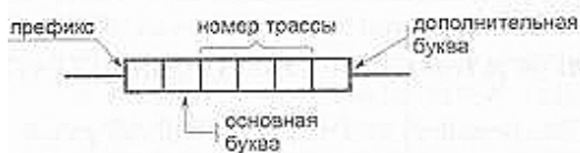
Рис. 5.2. Обозначение воздушной трассы.
